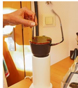
Heiß: Die Brillenfassung wird auf 160 Grad erhitzt, damit das Glas leichter eingesetzt werden kann.
